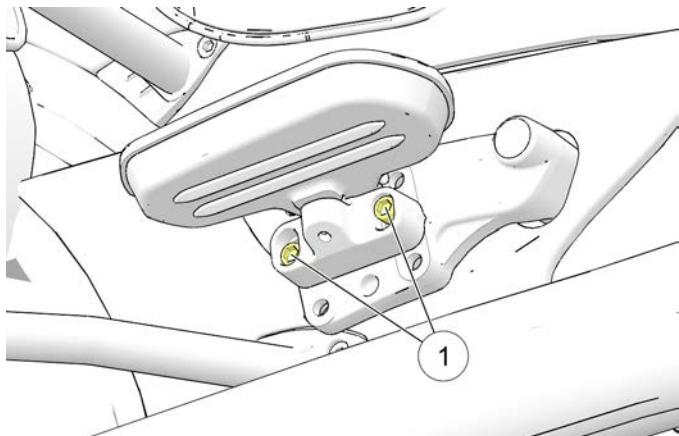
高さを調整するには、取付スクリューを2本とも取り外します。フロアボードアッセンブリーを動かして次の穴に合わせてから、スクリューを挿入して角度を調整し、スクリューを締め付けてください。
