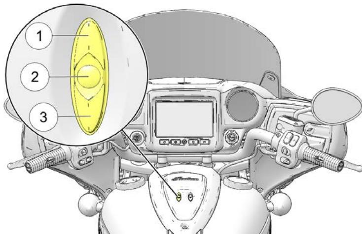
ヒーターの加熱の強さは、オフ（レベル0）から最強（レベル10）までの10段階です。加熱を強くするには、スイッチの上部①を押して放し、1段階ずつ強さを上げてください。加熱を弱くするには、スイッチの下部③を押して放し、1段階ずつ強さを下げてください。
