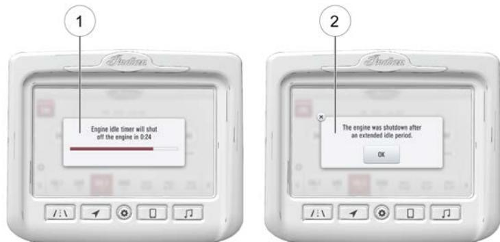
ライドコマンド装備車の場合、エンジン停止を警告するカウントダウンタイマーが表示されます①。残り時間がゼロになってエンジンが停止する場合、その通知が表示されます②。エンジン停止後もスタートアースイッチを押せばエンジンを再始動することができます。
