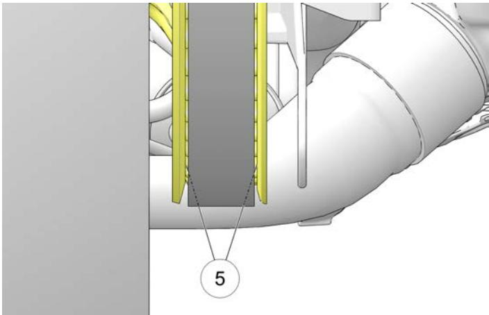
3. 必要な場合は、アクスルナットを緩めて、ホイールの前方回転中にベルトがドリブンスプロケットの右側フランジから離れて左右のフランジの中央を通り始めるまで、アクスルナットと左側アジャスターを緩めてください。
