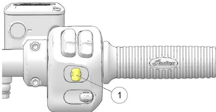
クルーズコントロールの操作と調整は右スイッチ部のクルーズコントロールスイッチ①で行います。
