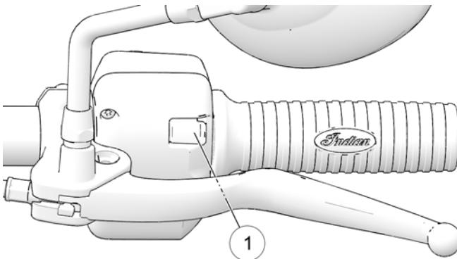
切替スイッチが機能するには、イグニッションスイッチがONになっていなければなりません。ライドコマンド装備車種の場合、右トリガースイッチを使用して、メニューの画面切替えができます。メニュー やダイアログボックスから戻る場合や、ダイアログボックスで「いいえ」を選択する場合、電話の通話を終了する場合、および表示画面を切り替える場合に左側スイッチを使用します。
