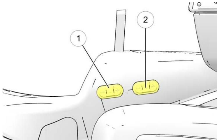
ライドコマンド装備車種では、ヒーターレベル変更時、タッチスクリーン画面にポップアップ画面が短時間表示されます。最初にシートスイッチを押すと、温度をライドコマンド画面で設定することができるようになります。ライドコマンドソフトウェアの更新後は、ライドコマンド画面で設定できるようにするために、スイッチをもう一度押してシートの電源を入れる必要があります。
