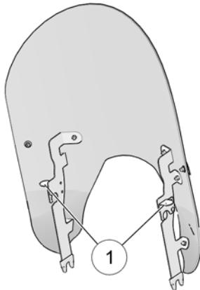
2. モーターциклの前方から、ウインドシールドの上部を強く引いて上側取り付け部から取り外し、次にウインドシールドを引き上げて車両から取り外します。
