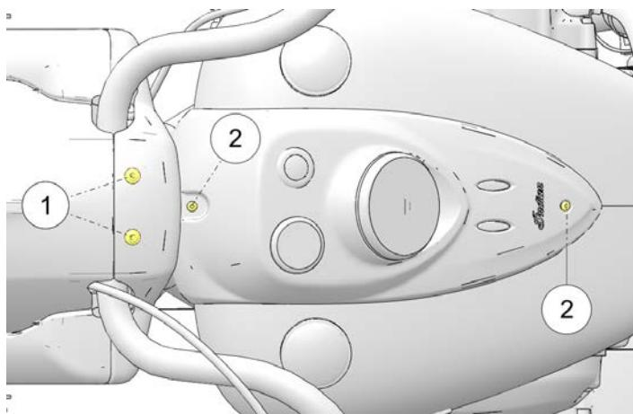
3. コンソールカバーを燃料タンクに固定している締め具②2本を取り外し、コンソールを後方に持ち上げて、あらかじめ保護しておいた燃料タンクに載せてください。
