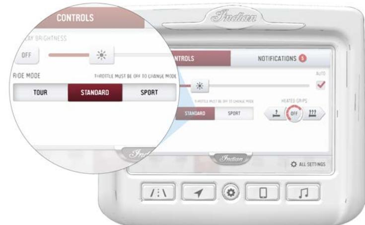
ライダーの運転スタイルに合わせて、(Tour, Standard, Sportツアーハンドル、スタンダード、スポーツ)の3種のライドモードが選択できます。各ライドモードのスロットルマッピングは、路面や走行状況の違いを念頭において設計されているため、1台のモーターサイクルに3種類の異なる個性を持たせることができます。
