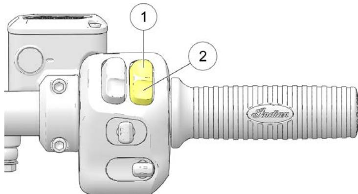
スイッチの上側（STOP）①を押すと、回路が遮断されエンジンが停止します。エンジンキルスイッチがSTOP位置にある場合は、エンジンの始動または作動はできません。
