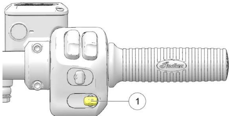
スイッチを押し上げると、ウインドシールドが上に動きます。スイッチを押し下げるとき、ウインドシールドが下に動きます。スイッチの上、または下を2回タップすると、ウインドシールドが最も上または最も下の位置に自動調整されます。ウインドシールドの移動中に反対方向のボタンを短く押すと、自動調整がキャンセルされます。
