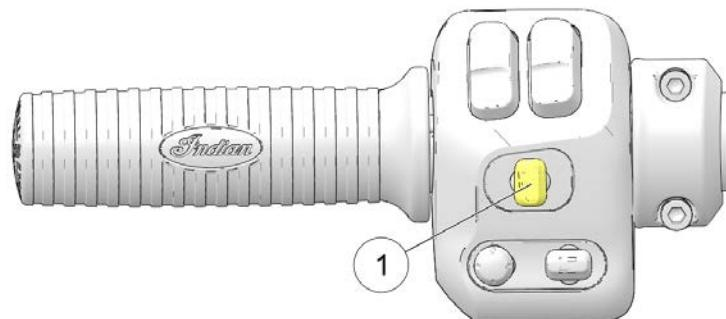
ハザードスイッチを作動させるには、ワインカースイッチ①の中央を押してください。
