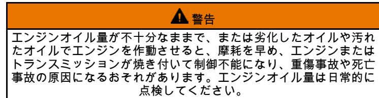
エンジンオイル量の点検は、必ず30秒間のアイドリング後に実施してください。オイル注入口/ディップスティックは、モーターサイクルの左側にあります。必ず指定オイルを使用してください。181ページを参照してください。
