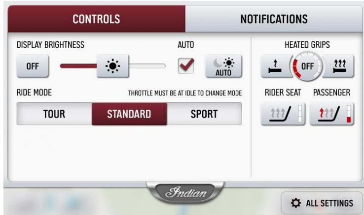
コントロールパネルから、各種設定、ディスプレイ明るさ調整、ライドモードの選択、車両空調操作が可能です。
