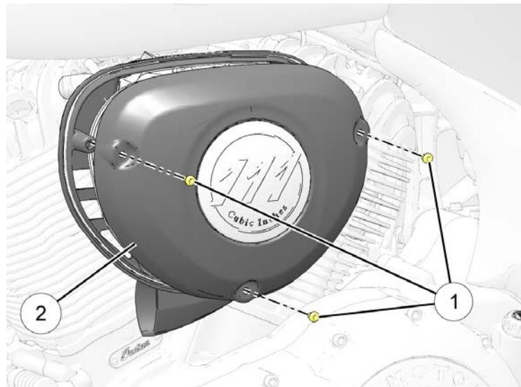
1. エアボックスカバーのスクリュー①を取り外して、カバー②を取り外してください。
